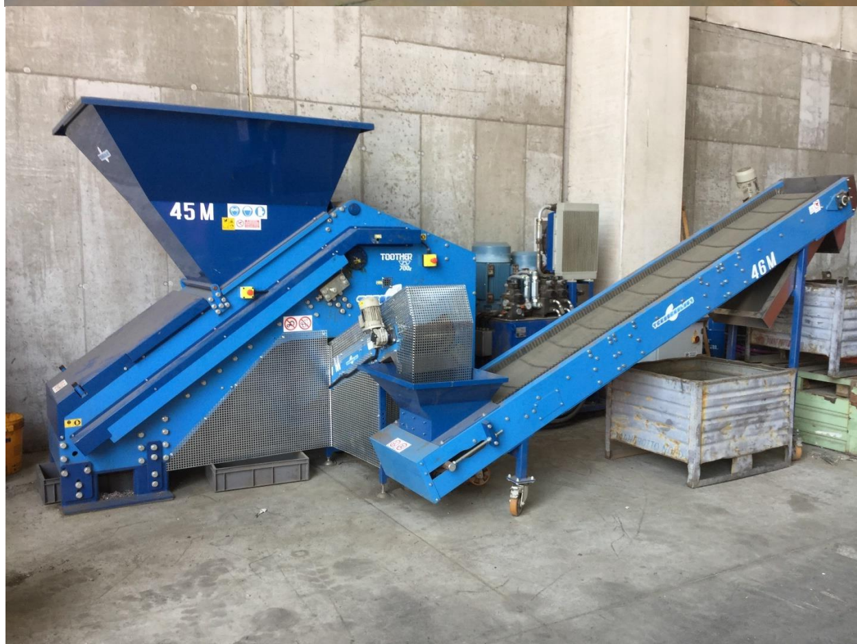
C19004 | Frantumatore idraulico utilizzato per la riduzione volumetrica dei rottami
